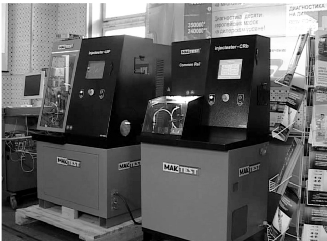
Общий вид стенда МАК TEST для проверки и ремонта форсунок
